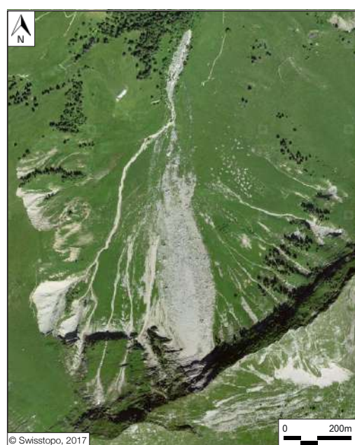
Fig. 2: Image aérienne de l'éboulement de la Dent de Lys.
